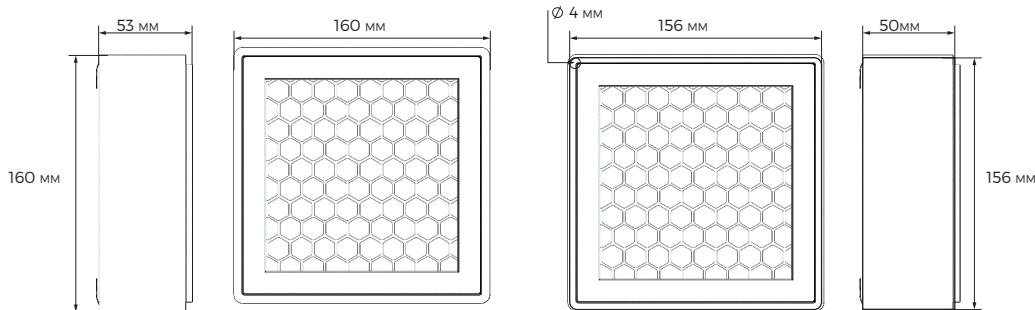
Dimension du filtre incluant le joint d'étanchéité en mousse
