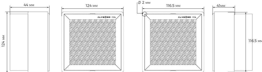
Les dimensions incluent la mousse d'étanchéité.
